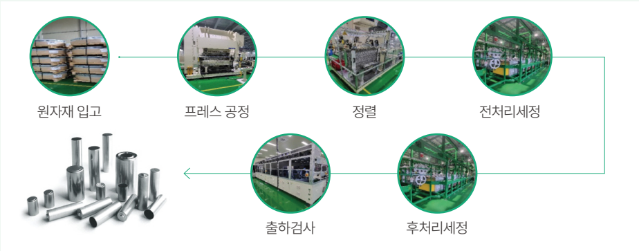
이차전지 원통형 캔 제조 공정(전기자동차용)
